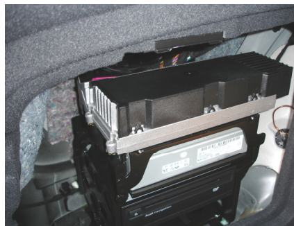
Foto: Verstärker im Modell ab 2006- . Kabelsatz 84065 ist richtig.
