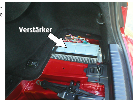
Abb.: Verstärker in IS250C mit ausgebauter Bodenplatte
