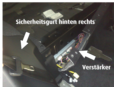
Abb.: Verstärker in RX series mit ausgebauten Rücksitzen
