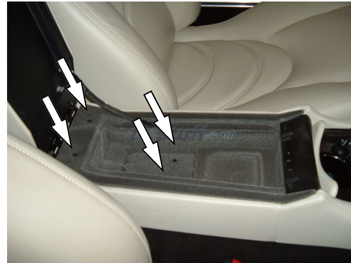
Abb.: 4 Schrauben in der Armauflage
